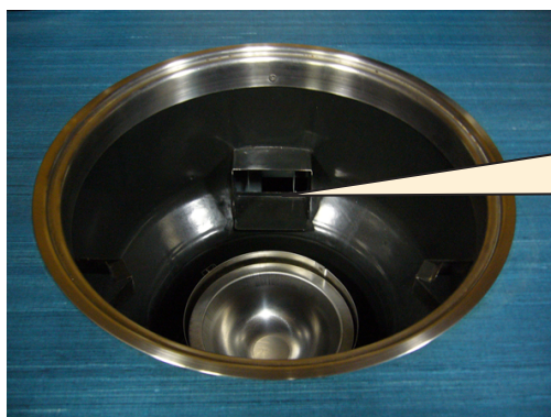
インナケーシング (内釜)、バーナ等を外した状態
