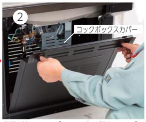
側板を外し、コックボックスカバーが見えなければ 反対側の側板を外す。
