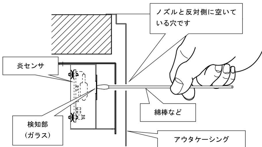
炎検知部が汚れたときは、綿棒や柔らかい濡れ雑巾などで、表面をきれいにしてください。検知部はガラス製ですので、強く押さえると破損する恐れがあります。
